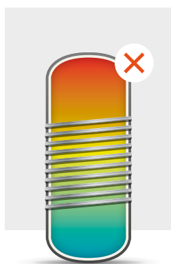
Cuve et échangeurs traditionnels
