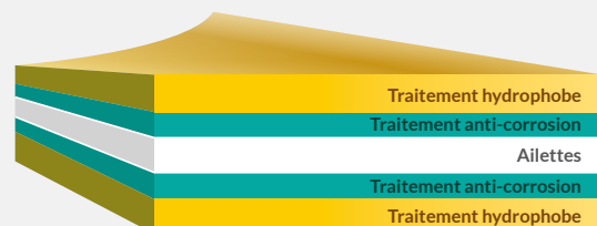
Double traitement des ailettes de l'échangeur
